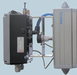
Пневмопривод DAPS-0106 с позиционером
