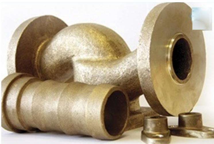
Металлургическое производство располагает базой для полного производственного цикла: есть участок по изготовлению деревянной модельной оснастки, плавильно-заливочный участок с необходимым формовочным оборудованием и оборудованием для финишной обработки отливок. Применяются следующие виды литья - литьё в разовые песчано-глиняные смеси, литьё по выплавляемым моделям, литьё под высоким давлением, литьё в кокиль.
